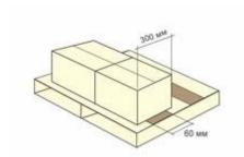
Потеря прочности при укладке на поддоне с зазором до 20% от стороны гофрояшика.
