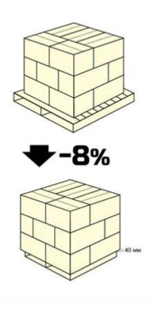
Потеря прочности при укладке на поддоне в перевязку с нависанием до 40 мм.
