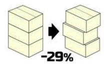
Потеря прочности при укладке ящиков колоннообразно со смещением до 30 мм.
