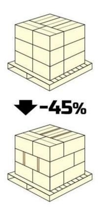
Потеря прочности при укладке на поддоне в перевязку без касания.
