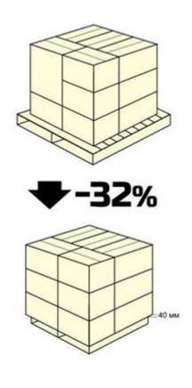
Потеря прочности при укладке на поддоне с нависанием до 40 мм.
